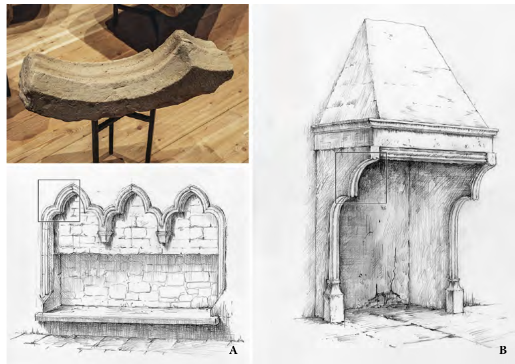
18. att. Divi no iespējamiem 1980. gadā atrastās akmens detaļas sākotnējās iebūves vietas variantiem – arkatūra (A) un kamīna sānu malas nobeigums (B)
