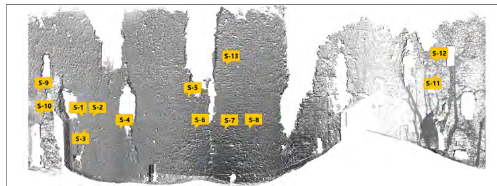
10. att. Priekšpils rietumu torņa ārsienas izklājuma attēls ar pētīto sastatņu balsta koka elementu atrašanās vietām (zemē nokritušo elementu atrašanās vietas attēlā nav parādītas) M. Kaļinka veiktais 3D lāzerskenēšanas dati, 2024
