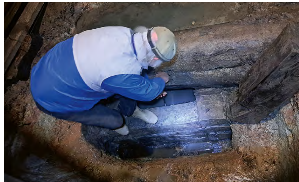
16. att. Raksta autors iegūst datēšanai nepieciešamos koksnes paraugus (serdeņus) ziemeļu torņa apakšējā pagrabtelpā G. Kalniņa foto, 2024
